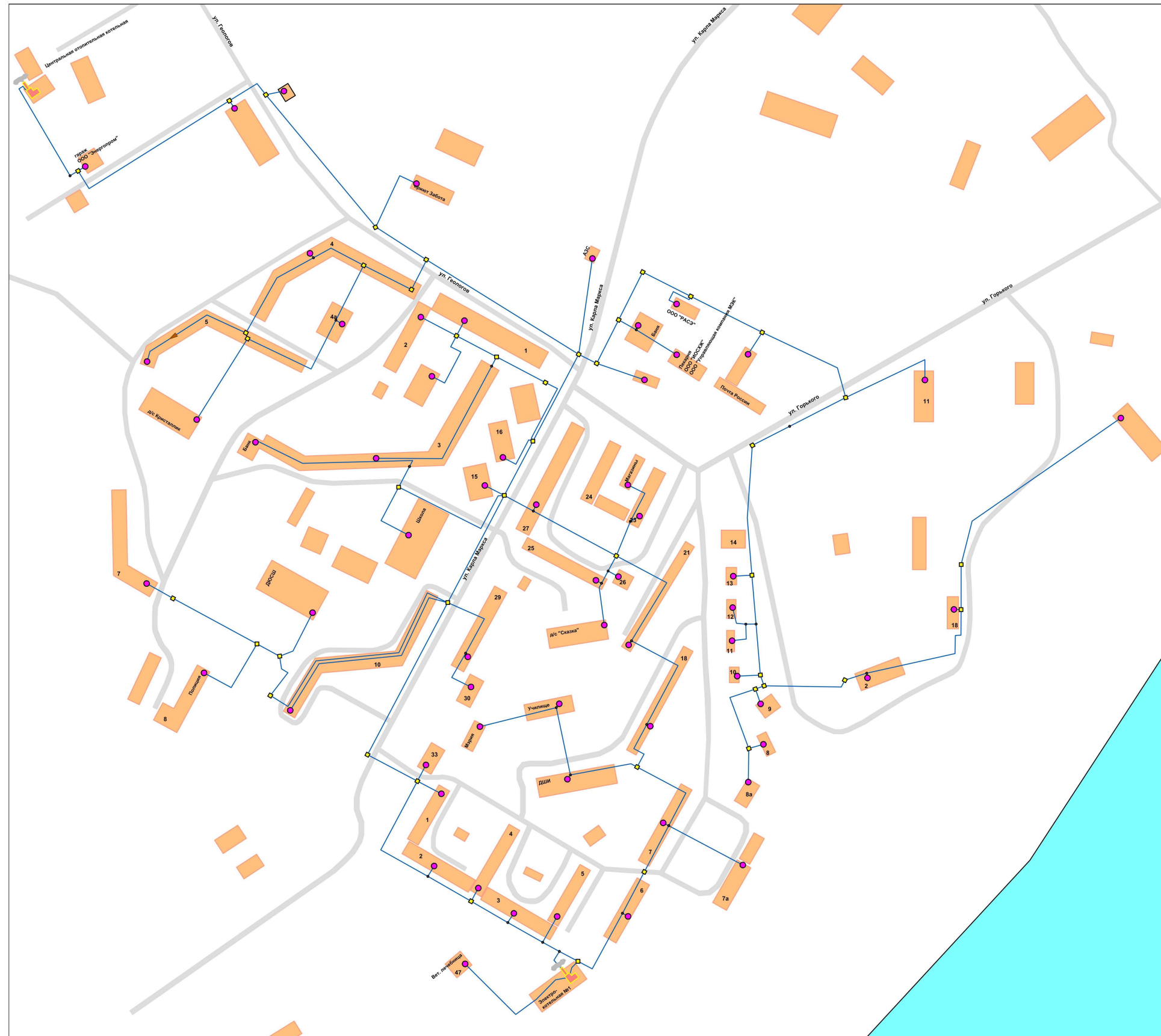
Рисунок 2.2.5. Существующая схема теплоснабжения от ЦОК и электрокотельной 1 микрорайона
