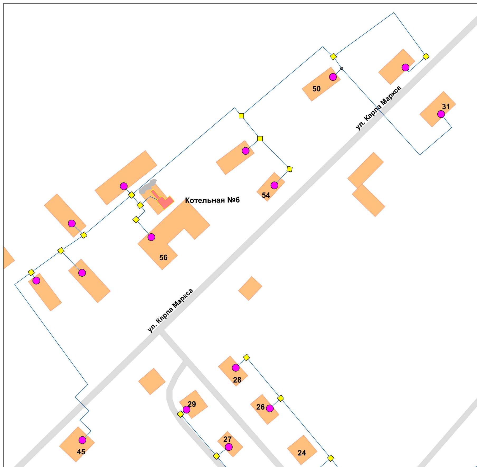
Рисунок 1.3.2.6. Схема прокладки тепловых сетей от электрокотельной №6.
